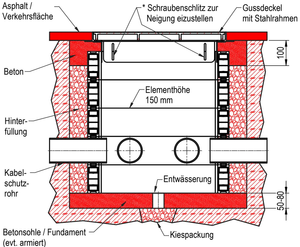
Die Betonsohle soll waagrecht und eben gegossen werden.
