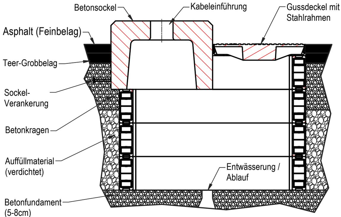
Beim Einbringen der Hinterfüllung und anschl. Verdichten muss die Diagonale der SYM-Box kontrolliert werden. Evt. Entwässerung / Ablauf einbauen.
