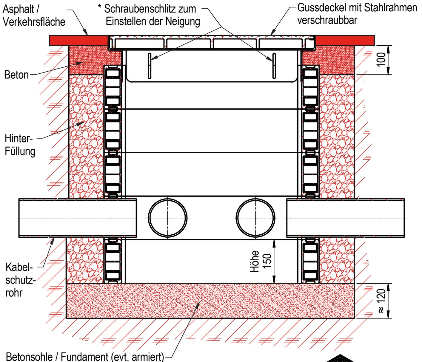
Die Betonsohle soll waagrecht und eben gegossen werden.
